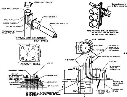
THE GROUND ROD SHALL BE FUSION WELDED TO A IC/\*8 A.W.G. SOLID COPPER GROUND WIRE, ATTACHMENT TO THE PRIMARY GROUND MAY BE BY AN APPROVED CLAMP. THE ROD IS TO BE LOCATED IN THE CONCRETE PULL BOX.
